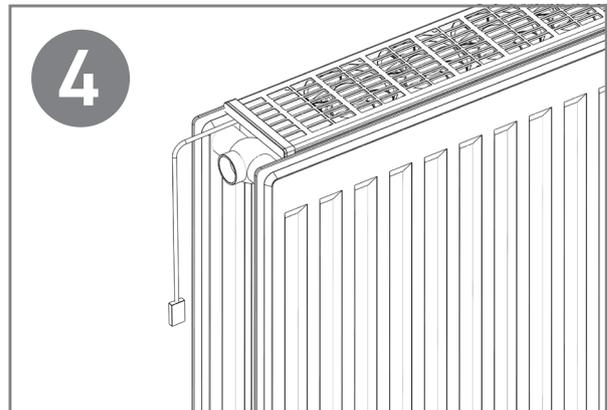
Placez le capteur de température magnétique entre les plaques du radiateur du côté de l'alimentation, c'est-à-dire du côté où se trouve le bouton. Branchez l'adaptateur électrique sur la prise la plus proche. Le Confort est maintenant prêt à l'emploi.
