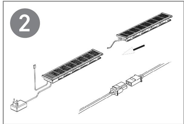
Verbinden Sie den Sockel und die Verlängerungen (je nach Länge des Heizkörpers) mit den Verbindungsstücken.
