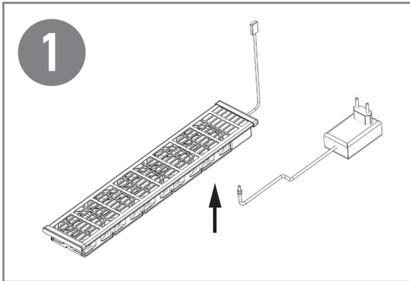
Nehmen Sie das Produkt aus der Verpackung und prüfen Sie den Inhalt. Schließen Sie das Kabel an die Basis an.
