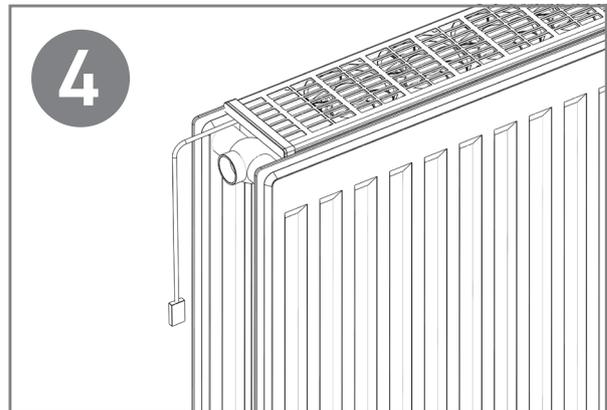
Bringen Sie den magnetischen Temperaturfühler zwischen den Heizkörperplatten auf der Vorlaufseite an, also auf der Seite, auf der sich das Thermostat befindet. Schließen Sie das System an die nächstgelegene Steckdose an. "The Comfort" ist nun einsatzbereit.
